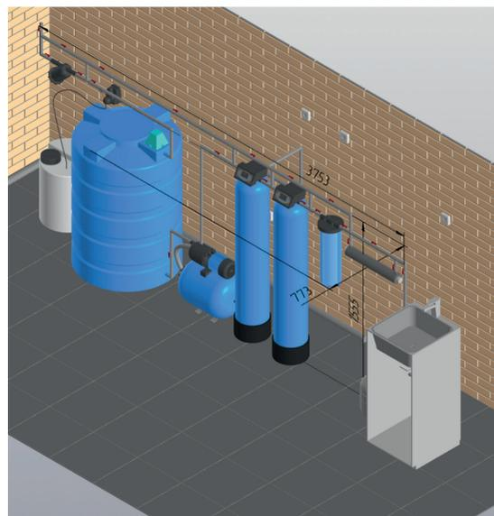
Рис.4 – Система контактной коагуляции Айсберг – Слева направо: дисковый фильтр, система дозирования коагулянта, ёмкость безнапорной аэрации, насосная станция повышения давления, фильтр осадочный или фильтр обезжелезивающий, фильтр сорбционный, фильтр тонкой очистки, ультрафиолетовый обеззараживатель
